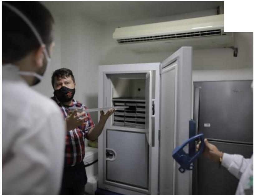
El ultracongelador tiene una capacidad de 338 litros y conservar hasta 2000 vacunas, a temperatura entre los -40 y los -80 grados centígrados.
