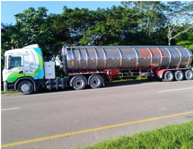
Tractocamiión marca Scania 6x4 dedicado a gas natural, tecnología Euro VI, genera reducciones superiores al 95 por ciento en las emisiones de material particulado en comparación con un vehículo Diésel.
