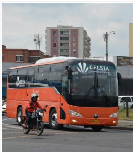
El bus también tiene frenado regenerativo, (un dispositivo que permite transformar la energía cinética del frenado en energía eléctrica que recarga la misma batería), cuenta con 215 kW de potencia y puede alcanzar una velocidad máxima de 100 km/h. Además tiene más comodidades que las de un bus tradicional: aire acondicionado, puertos USB, sillas reclinables, parlantes, pantallas de video, luces internas y externas con tecnología Led, entre otros.
