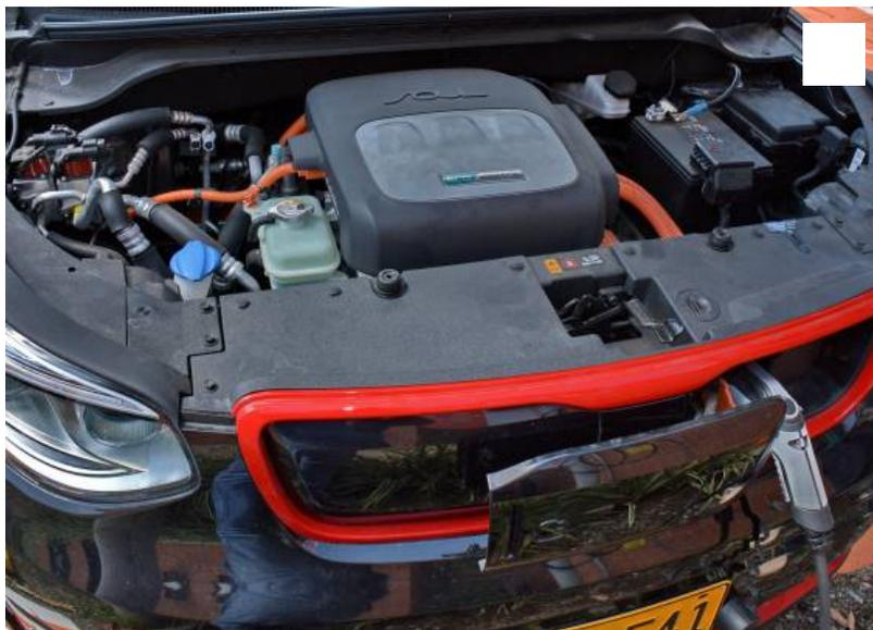
*El Kia Soul eléctrico se carga desde la parte delantera y el vehículo se puede conectar a cualquier toma de 110 voltios o a estaciones de carga especializadas como la que recientemente se abrió en*
